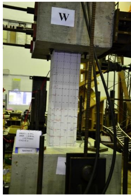
目標層間位移角 0.75%西側 (試體純水泥柱試驗照片)
