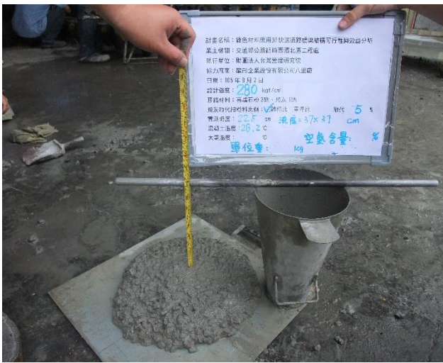
設計強度 280 kgf/cm 2 取代 5%(坍流度試驗)
