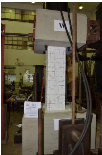
目標層間位移角 10%北側 試體爐灰 35:15 比例柱體試驗照片
