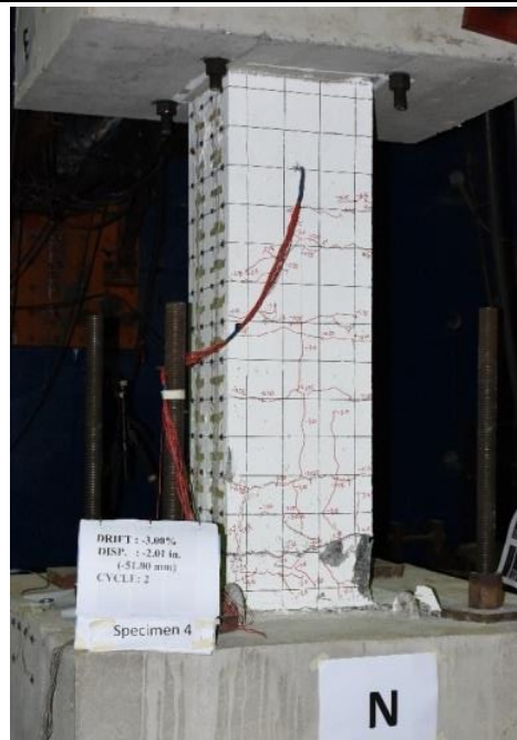
目標層間位移角 3%西側 (試體 IP(HS-LH)柱體試驗照片)
