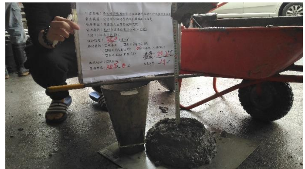
350 kgf/cm 2 坍度試驗 (混合水泥 IS(<70)(MS))
