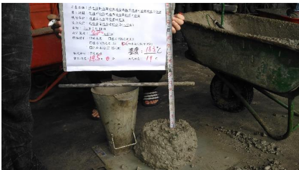
280 kgf/cm 2 坍度試驗 (混合水泥 IS(<70)(MS))
