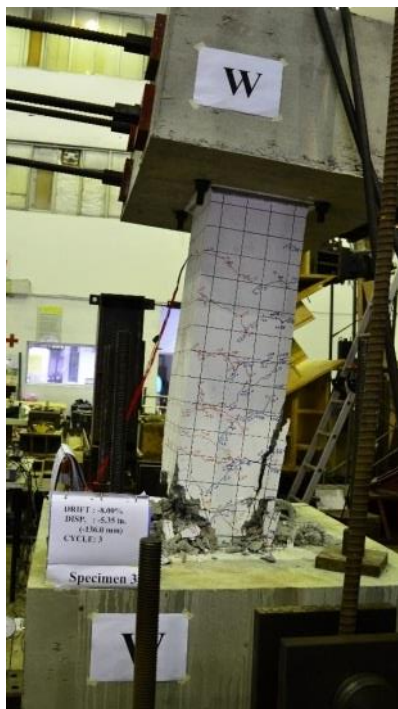
測試結東南側主筋挫曲 (試體 IS(<70)(MS)柱體試驗照片)
