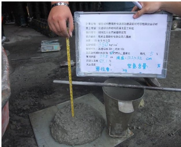
設計強度 350 kgf/cm 2 取代 5% (坍流度試驗)
