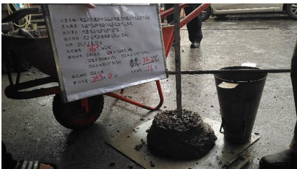
350 kgf/cm 2 坍度試驗 (爐灰比例 25:10)
