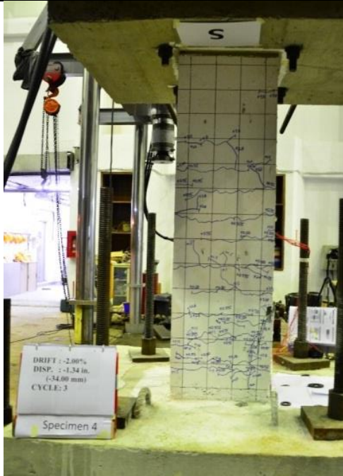
目標層間位移角 2%西側 (試體 IP(HS-LH)柱體試驗照片)
