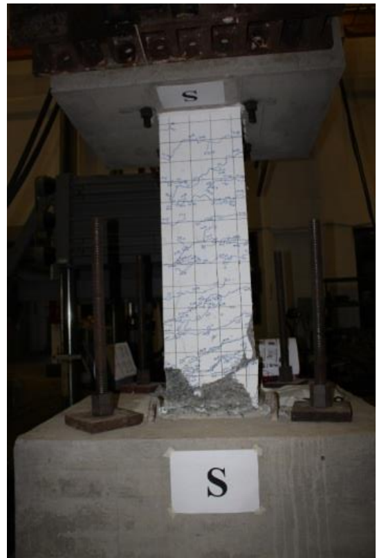
目標層間位移角 8%北側 試體爐灰 35:15 比例柱體試驗照片
