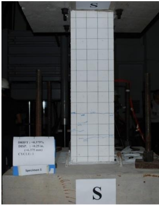
目標層間位移 0.375%南側 (試體純水泥柱試驗照片)
