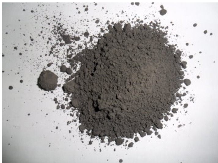
圖 3-9 研磨後之電弧爐爐渣外觀
