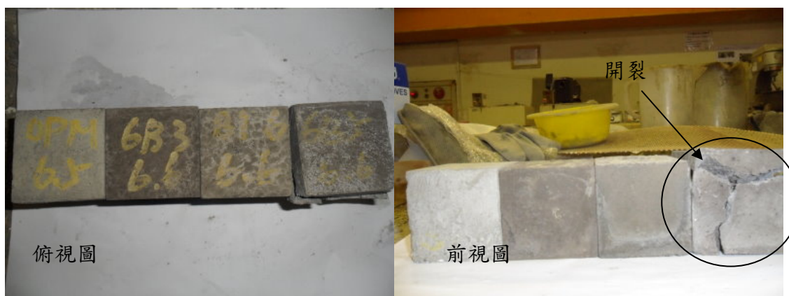
圖 4-17 轉爐鋼渣粉水泥砂漿試體膨脹及龜裂(細度 6000 \text{cm}^2/\text{g} )
