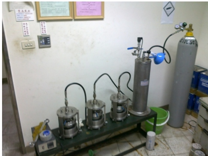
圖 3-13 混凝土透水試驗裝置
