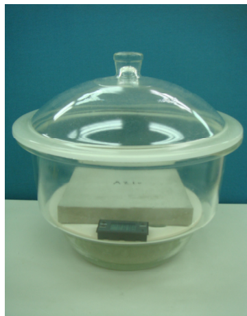
圖 5-29 吸(放)濕試驗裝置
