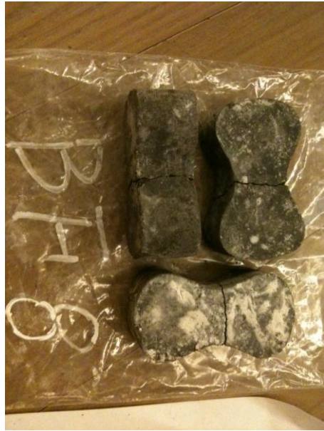
圖 3-6 8 字形試體經抗壓後劣化情形
