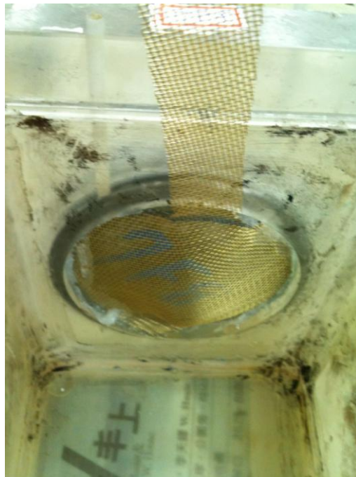
圖 3-16 環片置入導電銅網
