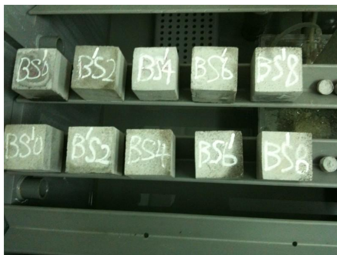
圖 3-22 5x5x5 cm 正立方試體置入鹽水噴霧機劣化情形
