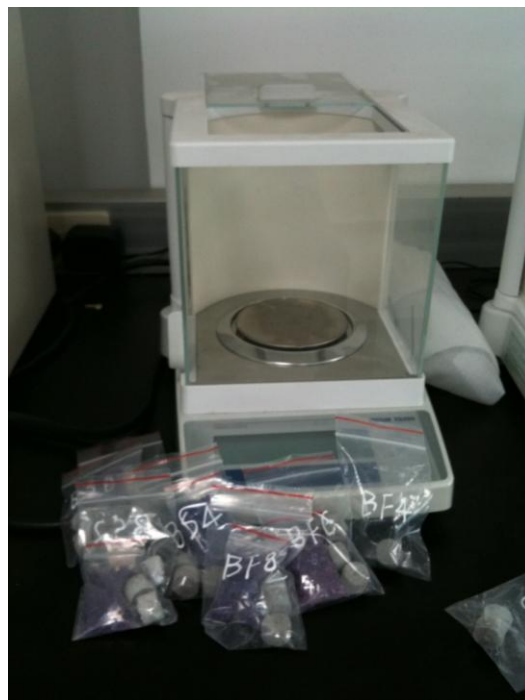
圖 3-10 壓汞孔隙(MIP)試體及精密測重儀
