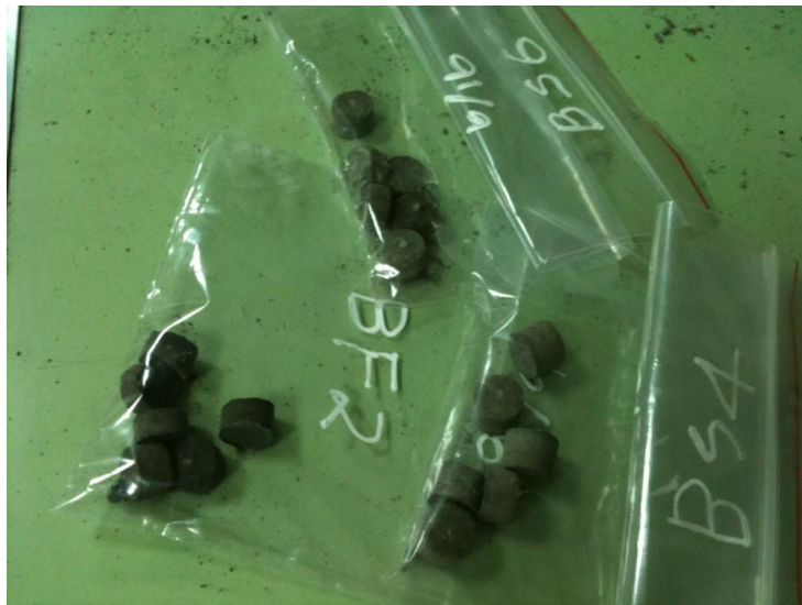
圖 3-9 壓汞孔隙量測小圓柱試體
