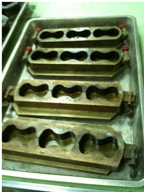
圖 3-5 8 字形水泥砂漿試體銅模
