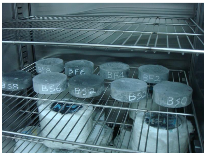
圖 3-14 3 cm 試體環片置入烘箱劣化
