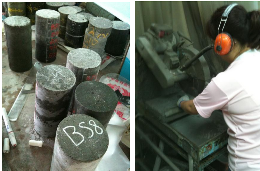
圖 3-13 摻料水泥砂漿圓柱及試體水刀切割機
