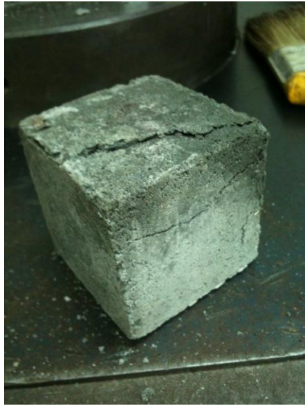
圖 3-2 正立方體水泥漿體經抗壓試驗後劣化情形
